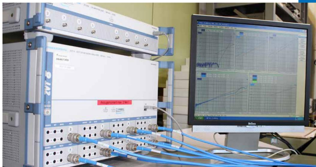
Mit dem Netzwerk-Analysator im Telegärtner-Labor sind hochpräzise, verlässliche Messungen möglich.
