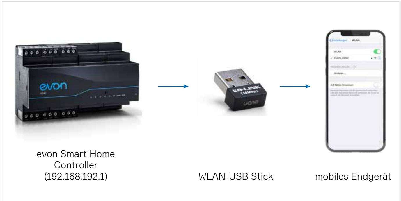
**Hinweis:** Findet keine automatische IP-Adressvorgabe statt (DHCP) kann der Controller auf der IP-Adresse 192.168.50.50 erreicht werden. Dies gilt nur bei Verwendung der Netzwerkbuchse am Controller (verkabelt). Eine Direktverbindung zwischen Laptop und Controller über ein Netzkabel ist somit auch möglich. Der Laptop muss hierzu lediglich mit einer statischen IP-Adresse im selben Bereich konfiguriert werden (z.B. 192.168.50.51 / 255.255.0.0).
